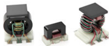
図5：磁性コア付き巻線型トランスの構造
