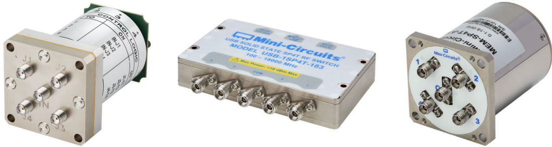
図1 : SP4TメカニカルスイッチZK-MSP4TA-18(左)、SP4TソリッドステートスイッチUSB-1SP4T-183(中)、MEMSスイッチMEM-SP4T-A18(右)。この中から1種類のスイッチのみを使用した設計ですべてのテストニーズを満すことは出来ません。多くの場合、性能、速度、切り替え回数のトレードオフが必要です。
