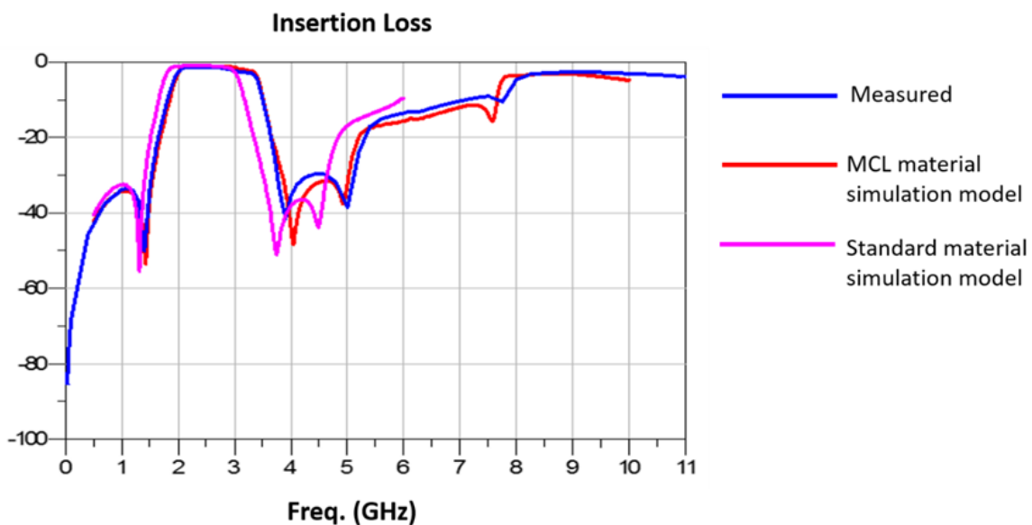
図3：標準シミュレーションおよびMCLの材料構造を加味したシミュレーションによるLTCCバンドパスフィルタのS21と初号機の実測値
