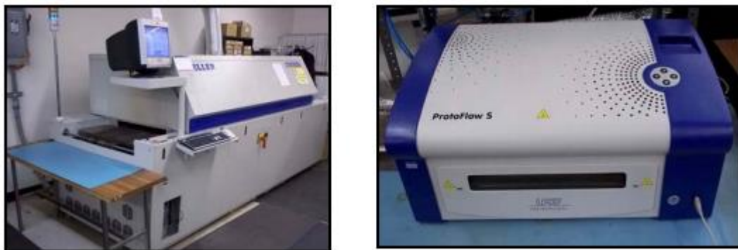
図 5: リフローオーブン(左)と卓上リフローオーブン(右)
