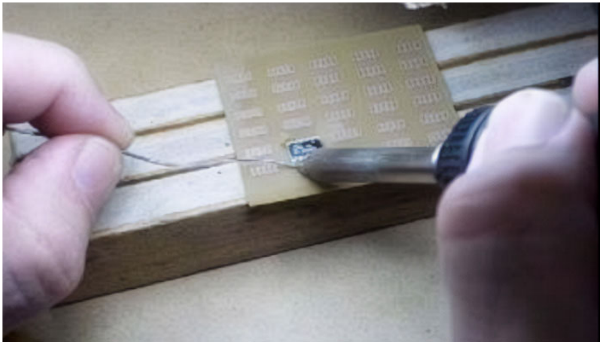
図2：手作業のはんだ付け
